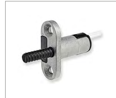
RIEGELSCHALTKONTAKT Im Schließblech eingebaut. Wird durch den Riegel im Schloss betätigt. Rückmeldung: Tür manuel oder mechanisch abgeschlossen!
